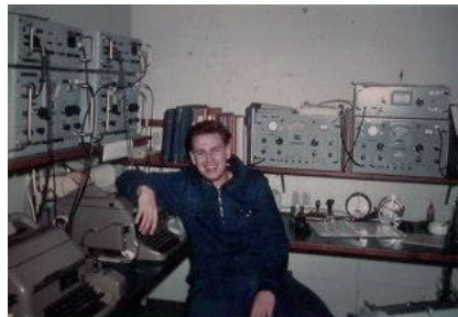
Kollega Knud Haargaard (1968). Man ser modtagerne til brug ved afsendelse hhv. modtagelse af RTTY, og man ser konverterne til brug dertil.
